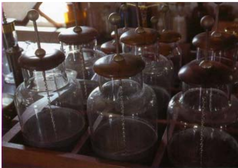
圖(一) 來登瓶(Leyden Jar) 人類第一個玻璃介質電容器
