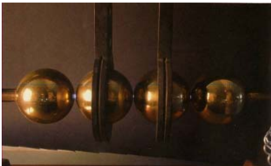
圖(三) 中間兩球為放電端，左右兩球為天線左右延伸的兩端。
